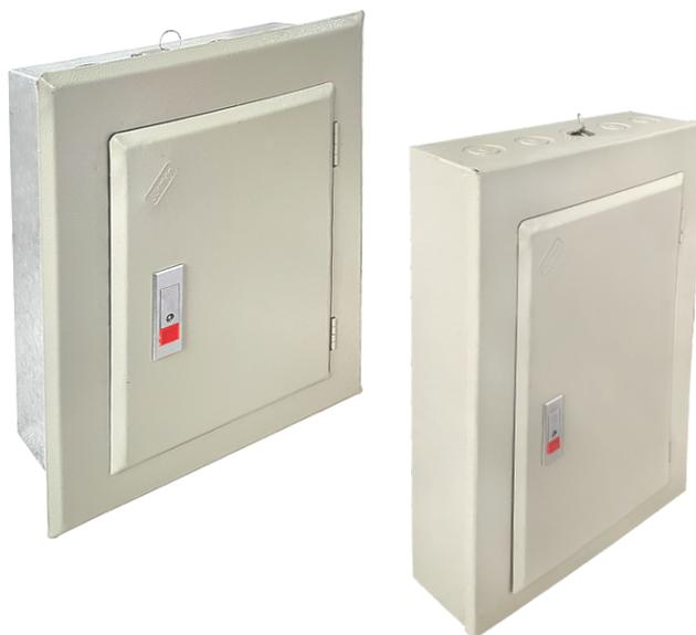
Los tableros son fabricados con planchas de 0.9mm, 1.2mm y 1.5mm de espesor, el cuerpo cuerpo pasa por un proceso de corte, troquelado, doblez, para luego ser unido con soldadura de punto, la tapa está sujeta a la caja por 4 stove bolt, según norma ITINTEC 370.040, los soportes y los rieles están sujetos por 4 stove bolt al cuerpo, y la línea a tierra está sujeta al cuerpo con remache pop de aluminio, las llaves tipo push de fácil apertura de puerta.
