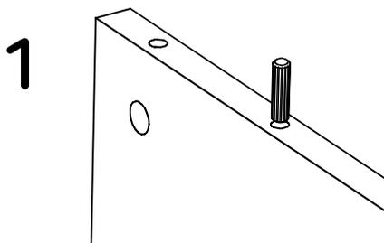
Inserta el tarugo en la perforación indicada y golpéalo suavemente hasta que llegue hasta el final de la perforación.
