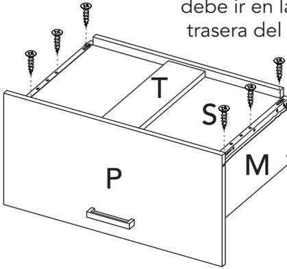
La rueda del riel debe ir en la parte trasera del cajón.
