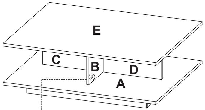
Al finalizar el ajuste de los conectores, proceda a poner las tapas minifix
